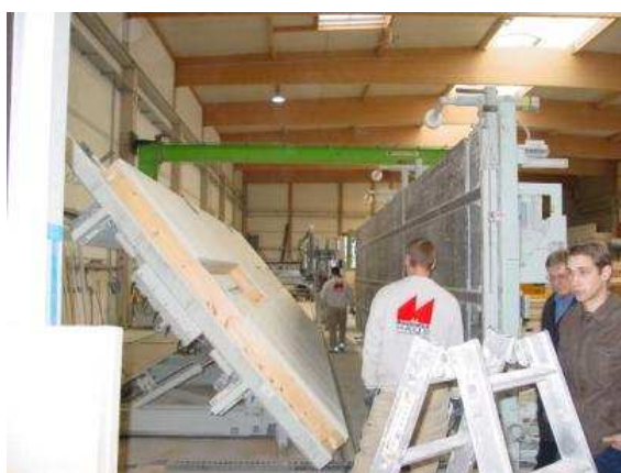
Abb. 10 - Wenden der Wand
