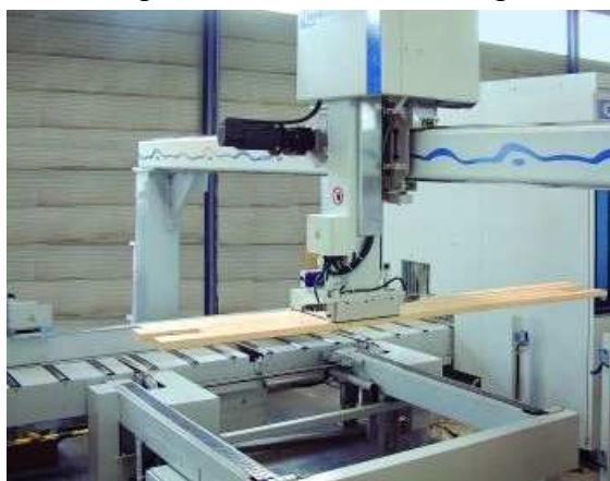
Abb. 80 - Handlingportal (Zuführung des Materials zum WBZ)
