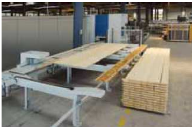
Abb. 81 - Ausgabe des Handlingportals nach dem WBZ
