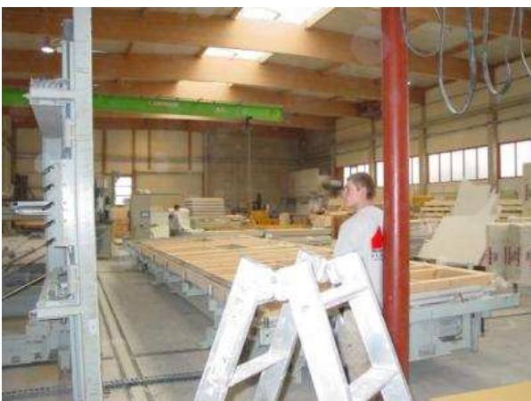
Abb. 7 - Auflegen der Hölzer auf den Bearbeitungstisch
