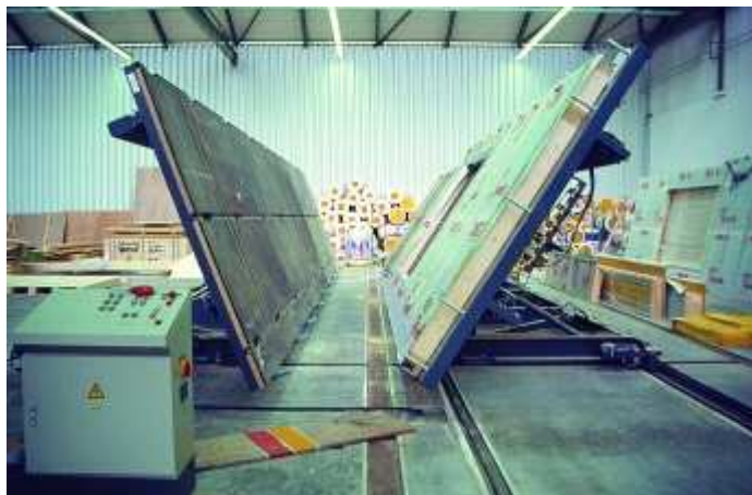
Abb. 84 - Wendevorgang eines Tafелеlementes
