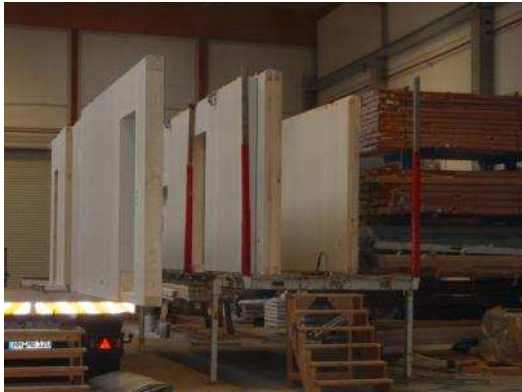
Abb. 16 - Verladen der Elemente
