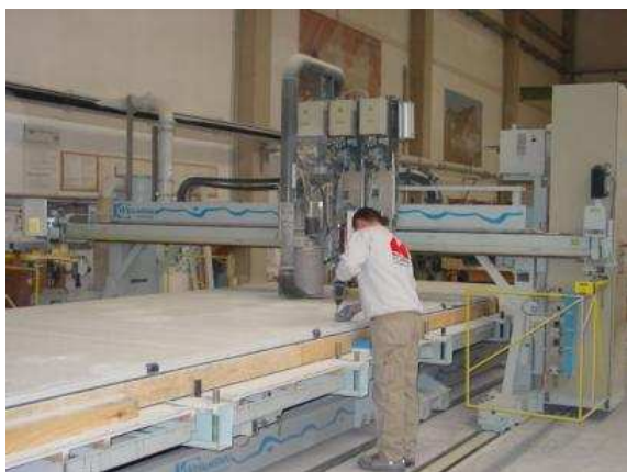
Abb. 9 - Bearbeitung der Fermazellplatten
