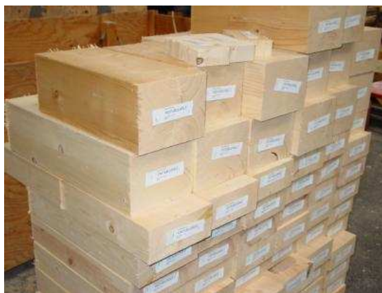
Abb. 6 - Kennzeichnung der Konstruktionshölzer
