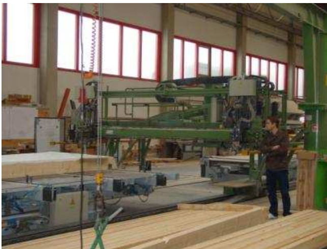
Abb. 12 - Bearbeitung der Dach- und Deckenelemente
