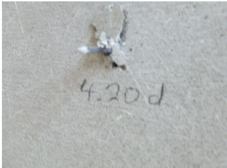
Abbildung 16 Versagen des Probekörpers bei 20d, Rückseite
