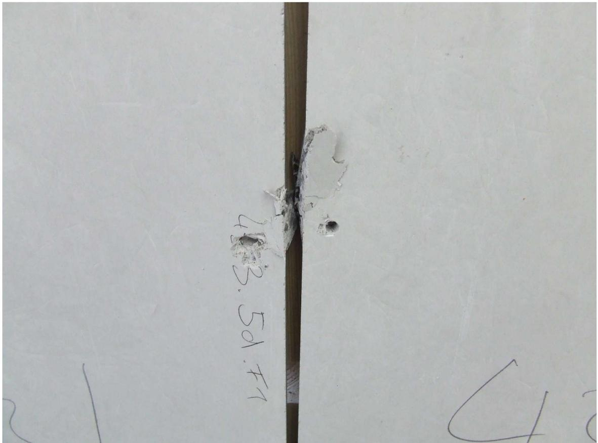
Abbildung 28 Versagen durch Kopfdurchziehen und Ausbrechen des Randes
