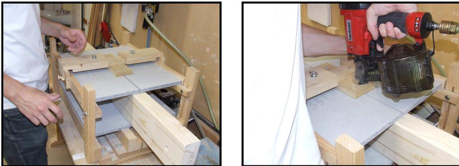
Abbildung 8 Vorrichtung zur Fertigung der Prüfkörper
