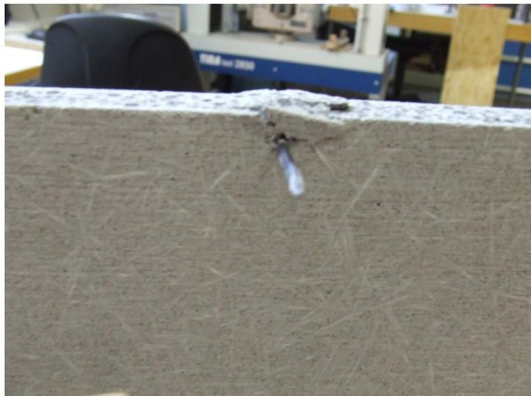
Abbildung 18 Versagen des Prüfkörpers bei  $3d$ , Rückseite
