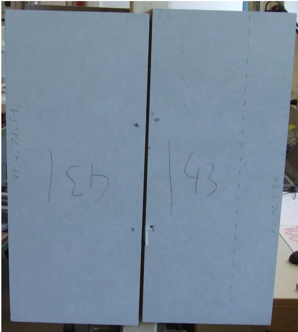
Abbildung 27 Versagen durch Verformung des Nagels und Ausbrechen des Randes
